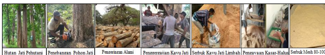
Gambar 2. Mekanisme produksi kayu jati dari pohon sampai dengan serbuk mesh 80-120
