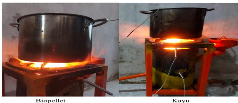
Gambar 5. Hasil Perbandingan Pembakaran Biopellet dan Kayu pada Kompor Biomassa.
