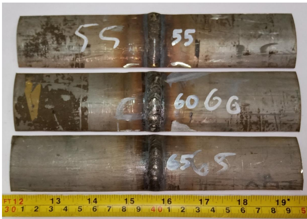
Gambar 3. Hasil pengelasan GTAW pada Arus 55 A, 60 A, dan 65 A
