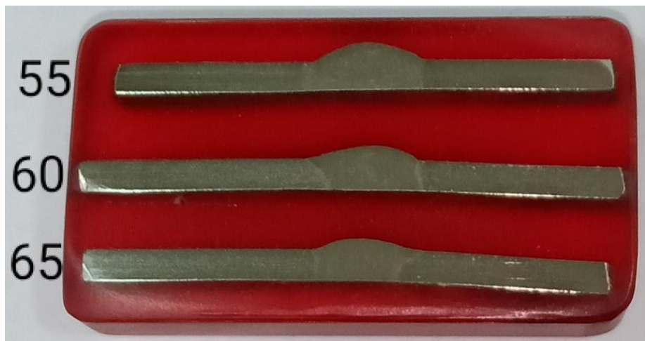
Gambar 2. Spesimen Uji Tarik untuk Tiga Kondisi Arus Pengelasan
