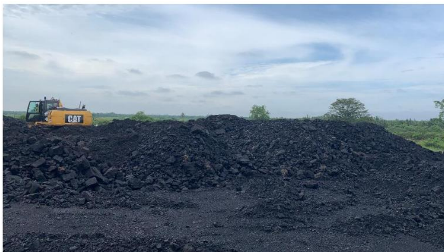
Gambar 5. Bentuk Timbunan Batubara pada ROM Stockpile
