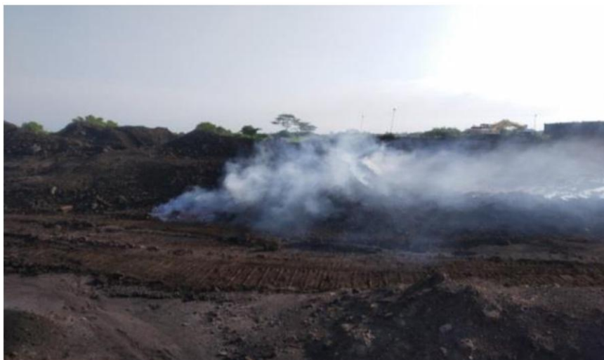
Gambar 9. Gejala Swabakar pada Area Stockpile PT Putra Muba Coal
