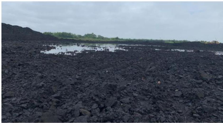
Gambar 4. Kondisi Lantai Stockpile dan Genangan pada Area Penelitian
