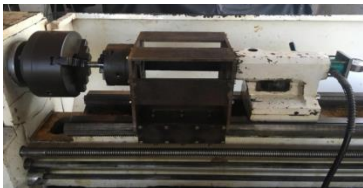
Gambar 4. Hasil Alat Bantu Tekan Berbasis Hidrolik
