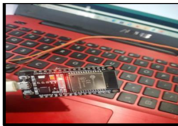
Gambar 5. Pengujian NodeMCU sebagai Output Indikator LED Mati
