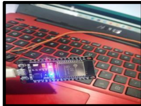
Gambar 4. Pengujian NodeMCU sebagai Output Indikator LED Nyala
