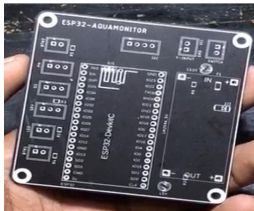
Gambar 4. PCB yang Sudah di Rakit
