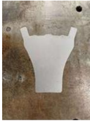
Gambar 5. Hasil Proses OP05 Blanking (Sumber: Dokumentasi Pribadi)
