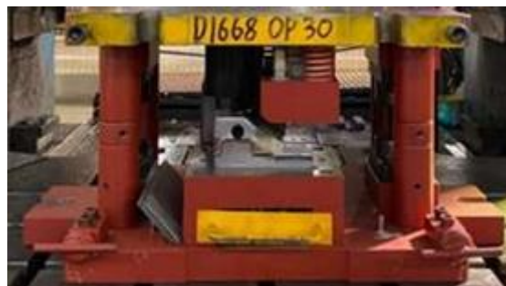
Gambar 10. Dies OP30 Pierching (Sumber: Dokumentasi Pribadi)
