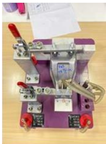
Gambar 13. Pengecekan dengan Checking Fixture (Sumber: Dokumentasi Pribadi)
