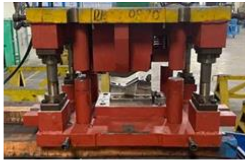
Gambar 8. Dies OP20 Bending (Sumber: Dokumentasi Pribadi)
