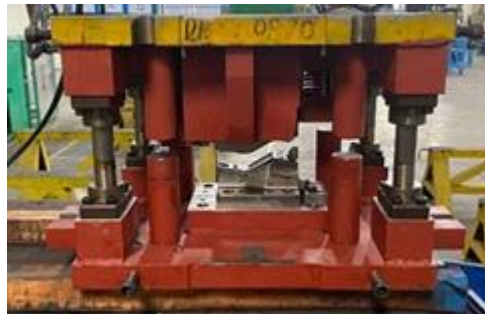
Gambar 6. Dies OP10 Forming (Sumber: Dokumentasi Pribadi)
