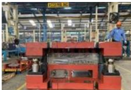
Gambar 4. Dies OP05 Blanking (Sumber: Dokumentasi Pribadi)
