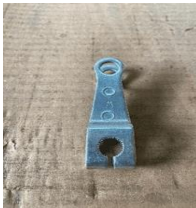
Gambar 10 Arm Brake sudah Plating
