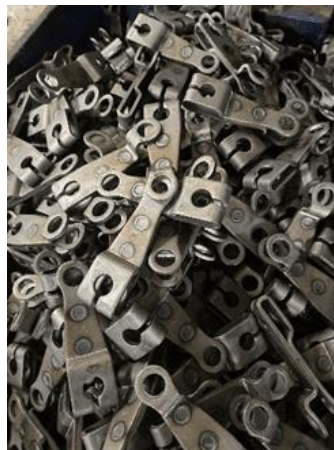
Gambar 9 Arm Brake sebelum Plating
