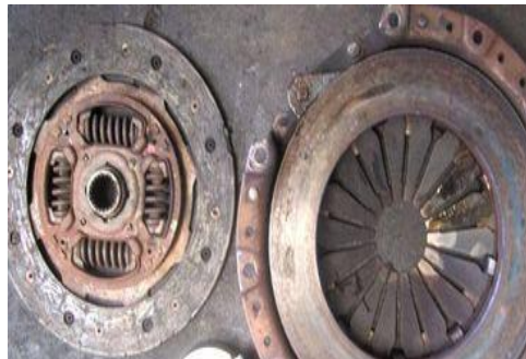
Gambar 1. kerusakan pada Kopling
