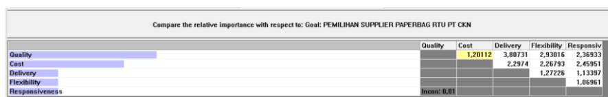
Gambar 12. Perbandingan Berpasangan Kriteria
