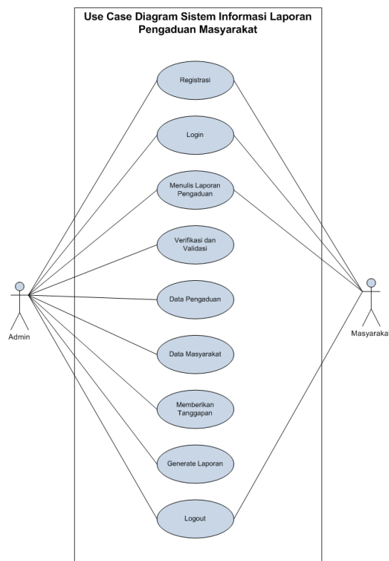
Gambar 1. Use Case Diagram Perancangan Sistem Informasi Laporan Layanan Pengaduan Masyarakat Berbasis WEB
