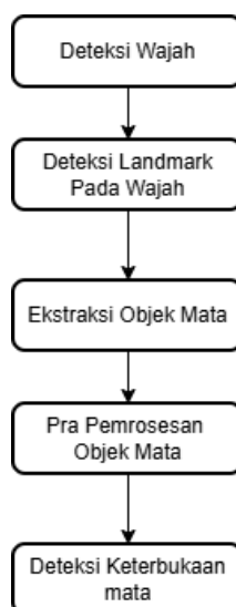
Gambar 1. Diagram alur Deteksi Keterbukaan mata
