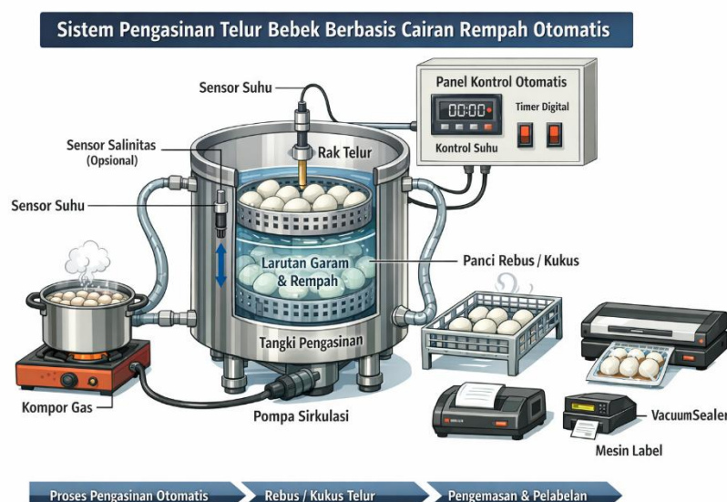
Gambar 1. Alat Teknologi Pengasinan Cairan Rempah Otomatis
